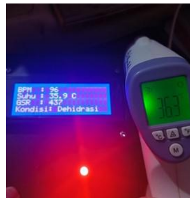
Gambar 1. Hasil Kalibrasi DS18B20
